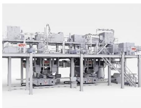
**图片说明：**欧瑞康非织造布的熔喷工艺是市场公认的用人造纤维生产具有高度分离和净化性能的过滤介质最高效的技术方法。（图片版权/照片：欧瑞康）
