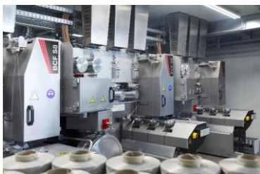
图片说明： 该纱线是在配备 BICO 纺丝箱体的纽马格 S8 BCF 设备上生产的。
