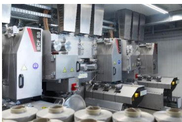
Bildunterschrift: Das Garn wurde auf einer Neumag S8 BCF-Anlage mit BICO Spinnbalken gefertigt.
