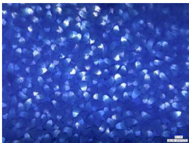
Bildunterschrift: Filament Querschnitt von BICO BCF 70% PET / 30% PBT.
