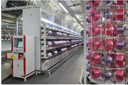
图片说明： 巴马格的 eAFK Big-V 加弹机可经济高效地生产高品质高纤度纱线，满足高要求的地毯和家用纺织品应用需求。
