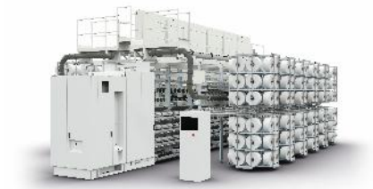
图片说明： BB Engineering 公司的 JeTex®空气变形设备将产品范围扩展至高品质 ATY 纱线，其高度的灵活性和高效的生产流程令人信服。
