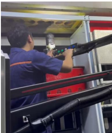
图片说明： 电动纺丝组件更换装置可协助操作人员更换重量大的纺丝组件，提高了作业安全性，并减少了纺丝设备的停机时间。
