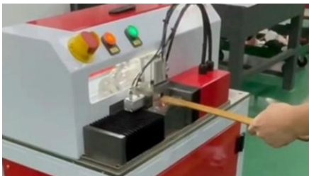
图片说明： 巴马格自动铲板刀磨刀机可确保磨削结果始终如一，从而有助于减少工艺波动。
