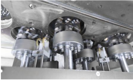
图片说明： 巴马格铲板机器人通过全自动喷丝板清洗，助力于提高工艺稳定性。
