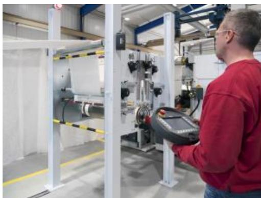
Mit der Oerlikon Neumag Elektrocharging-Einheit lassen sich auch Filter der Klassen EPA und HEPA herstellen.
