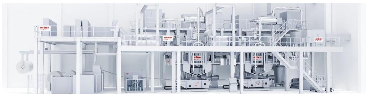
**Didascalia:** impianto a doppia trave Oerlikon Nonwoven - in questo caso con ecuTEC+ integrato per caricare elettrostaticamente i mezzi.
